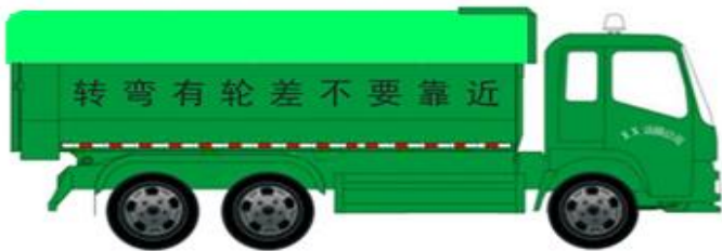
图 B.1 工程渣土车辆车身标识样式
